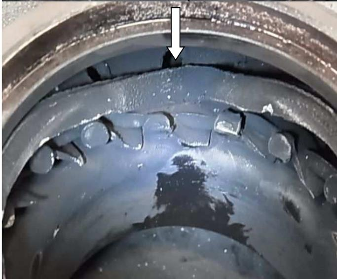
三菱ふそう6M60に装着されているターボチャージャーでタービンハウジングが高温の為、歪み、亀裂の発生が多発しています。
