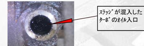
オイル汚れ及びゴミが混入した場合シャフト軸受部及び、ベアリング表面に強いかじり傷が残ります。
