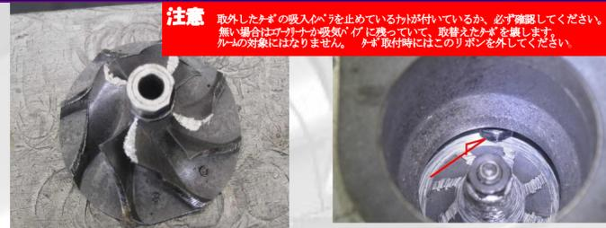
**注意** 取外したターボの吸入側ベアリングを止めている物が付いているか、必ず確認してください。無い場合は必ず吸入側ベアリングに付いている、取替えたターボを壊します。ターボの向きにはなりません。ターボ取付時にはこのベアリングを外してください。
