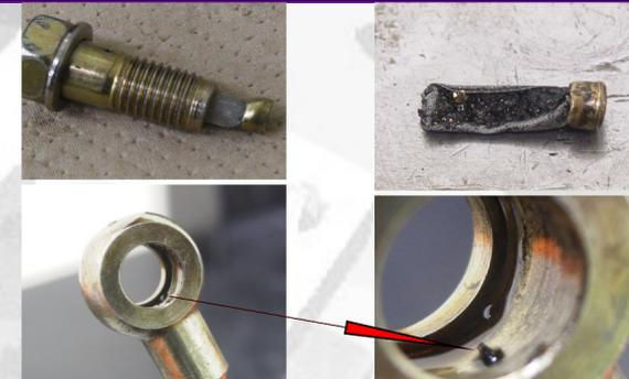
エンジンからのオイル供給が不足したり、一時的な油膜切れによって、超高速で回転しているシャフトは瞬間的に高温(真っ赤)になりベアリングと焼付いてしまう。シャフトに焼が入った紫色(デーパーカー)が残るのが特徴
