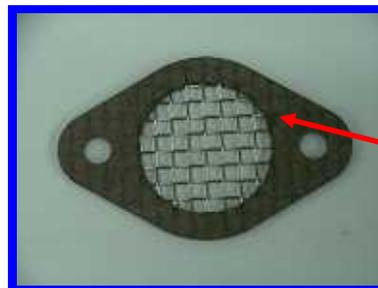
スズキ用ガスケットには飛込み防止ネットがはってある(TTS製)
