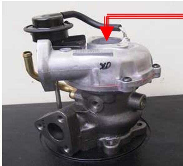
取り外したコアを吸入側から覗いて下さい、シャフトの先端にインペラ締付のナットが付いているはずで
