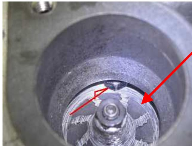
ナットが外れて無く、外れたナットで羽根が破損しています。
