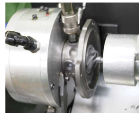
ローターシャフト ピストリング溝加工修正
