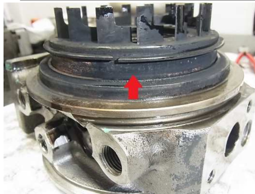
排気側VNT機構炭化物堆積
