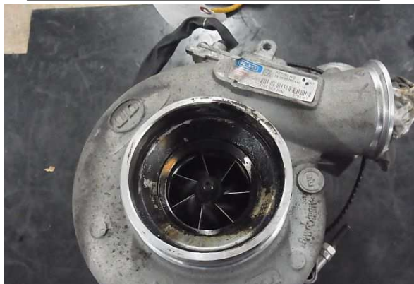
吸気入口オイル吸い込み
