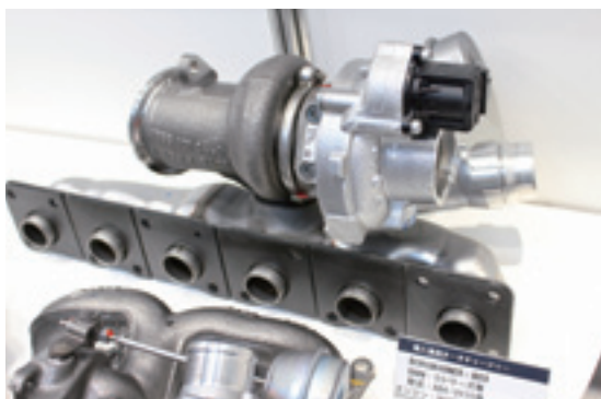
自然吸気+直6が往年のBMWの代名詞となっていたが、現代のBMWは直噴ターボが主流。ブースには5シリーズ用のボルグワーナー製ターボチャージャーが展示されていた。TTS (ターボテクノサービス) ではディーラーからの依頼も多いという。技術や完成度において高い信頼を得ている証である。
